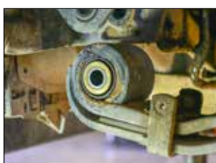
Einbausituation einer geschlitzten und gespannten Buchse
